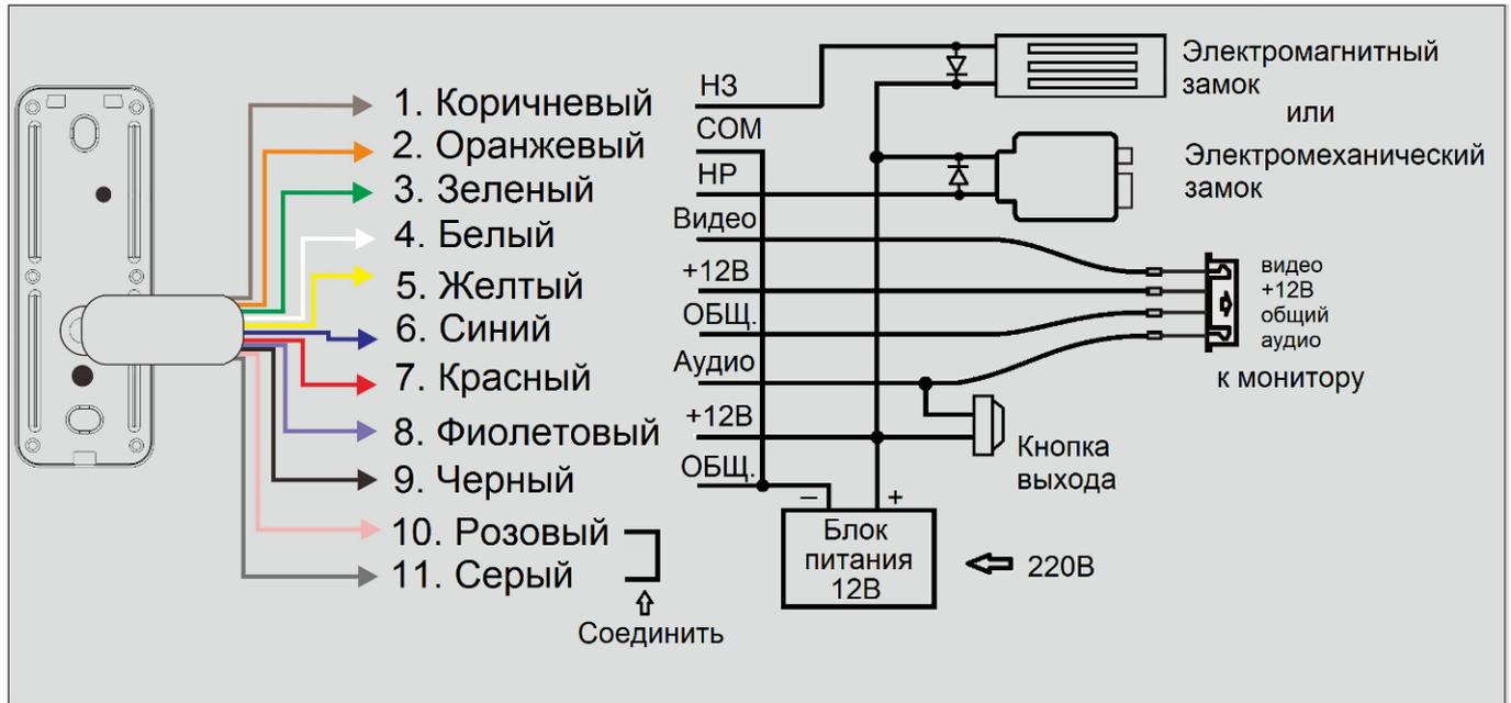
**Внимание:** Если в замке отсутствуют установленные при производстве защитные элементы или цепи размагничивания, то обязательно установите диод (из комплекта поставки) или варистор на 18-20 вольт (при питании замка от 12-15В), параллельно обмотке замка, для гашения импульсов самоиндукции замка. При отсутствии защитного элемента реле панели может быть повреждено, что не является гарантийным случаем.
