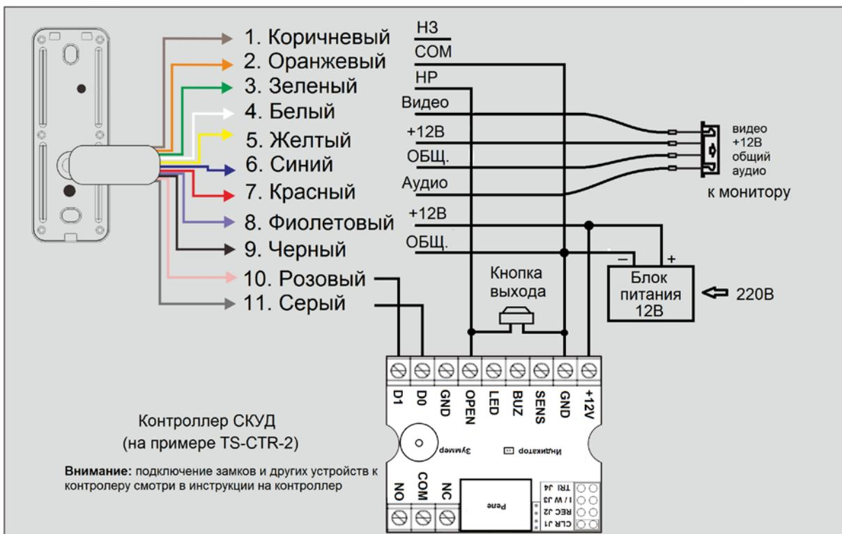
**Внимание:** Запрещается использовать провода одной пары в кабелях типа UTP/FTP (витая пара) для подключения сигналов D0 и D1. Сигналы D0 и D1 должны быть подключены через разные пары, при этом второй провод пары должен быть подключен к общему проводу контроллера.
